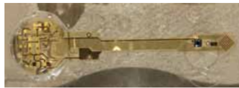
Dr. Matthias Keserü mit dem Chip, der künstliches Sehen ermöglichen soll. Die Elektroden in der verschweißten Folie stimulieren die Nervenzellen der Netzhaut
