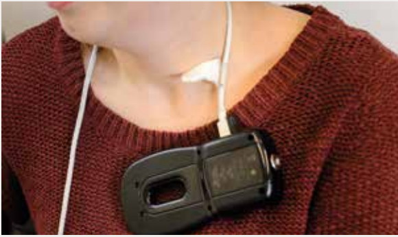
Antenne für den Hirnschrittmacher: Per Telemetrie wird der implantierte Impulsgeber ausgelesen und programmiert
